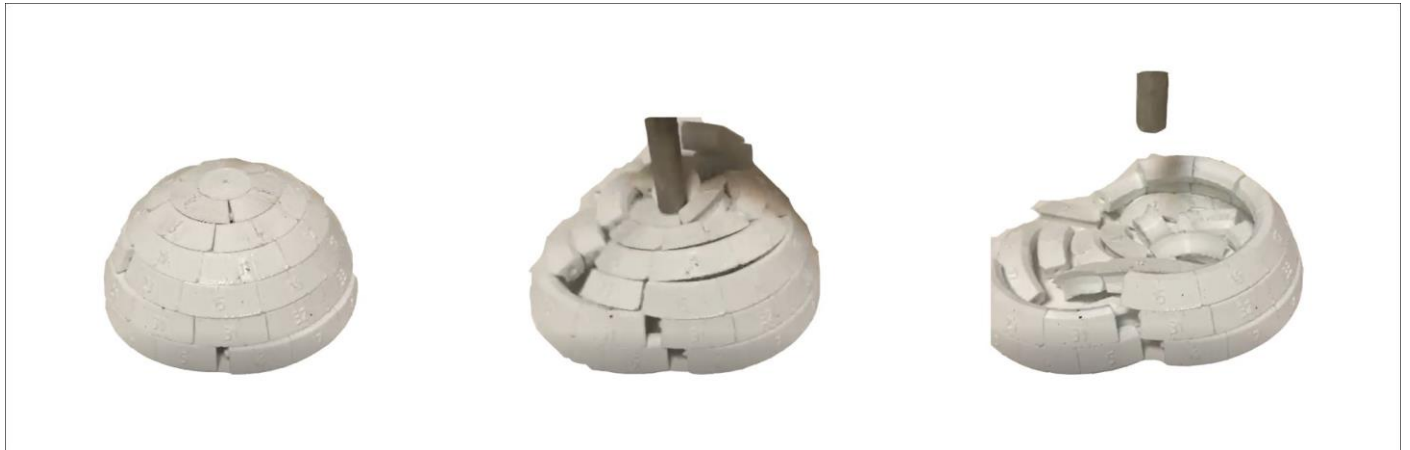
Şekil 8: Fiziksel modelin gözleme dayalı deney ortamı altında basınç çubuğu ile analiz edilmesi
