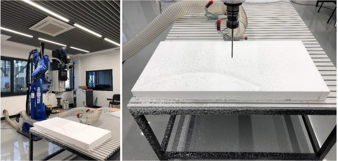
Şekil 7: Robot kola entegre edilmiş spindle motor ile gerçekleştirilen frezeleme işlemleri
